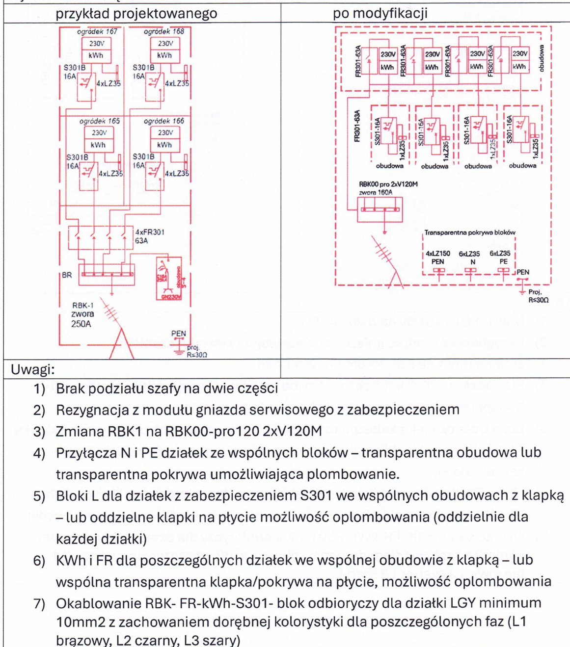
Rysunek nr 3. Złącze kablowo licznikowe dla 4 odbiorów
